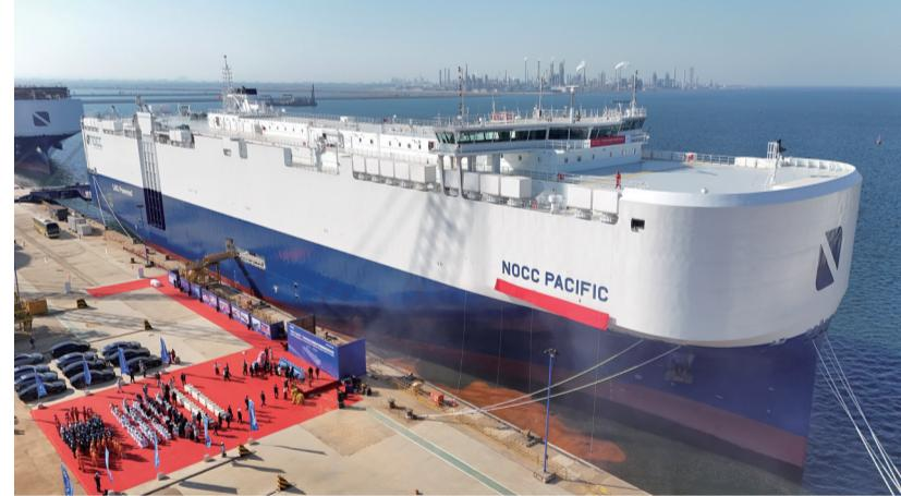
11月14日，由中集来福士为挪威建造的7000车位LNG双燃料汽车运输船“NOCC PACIFIC”号在山东省龙口市完工并举行命名仪式。该船针对新能源汽车运输安全做出了专门设计，可满足将于2026年1月1日起强制实施的《国际海运危险货物规则》第42-24修正案要求。这是当日中集来福士集团龙口建造基地拍摄的“NOCC PACIFIC”号汽车运输船（无人机照片）。
