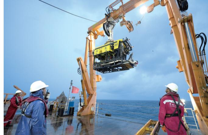
8月23日清晨,在南海的晨曦中,我国自主研制的6000米级深海无人遥控潜水器(ROV)“海琴”号,经过8个小时作业,从4140米深海凯旋,成功进行海试,我国深海研究又多了一个“科考利器”。“海琴”号由上海交通大学水下工程研究所自主研制,是为“中山大学”号海洋综合科考实习船量身定制的新型高效深海电动ROV系统,搭载了高清摄像机、多功能机械手、探测传感器等科考设备,具备自动定向、悬停定位、自动巡航等智能作业能力。
