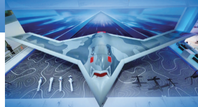
彩虹-7是基于先进的气动、隐身和控制技术研制的高空亚音速无人机
